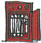
屋内消火栓設備
